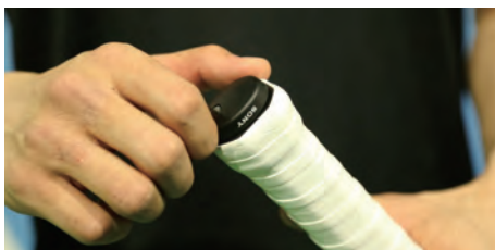
ボール速度、回転数、スイング速度を測定。改善の前後の差が明確に。
